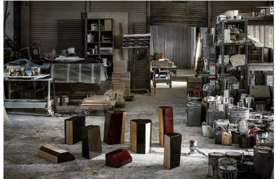
突板の工場を見学した時、「フリッチ」と呼ばれる、丸太をソマ角に製材したものの端部が切り落とされ焼却されていることを聞いた。
